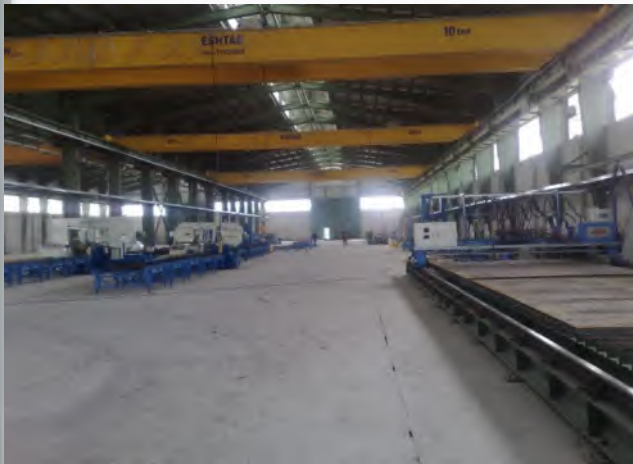
نمای داخل سالن دو قلوئی شماره ۳ و ۴ که دارای دو دهانه به عرض ۲۵ و طول ۱۰۰ متر
