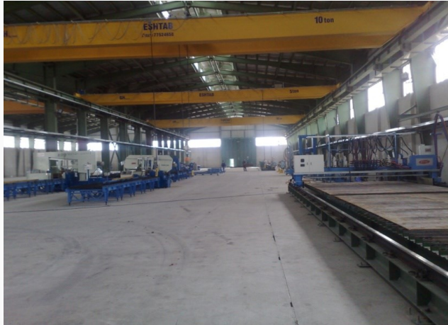
نمای داخل سالن تولید دو قلوی شماره ۳ و ۴ دارای دو دهانه به عرض ۲۵ و طول ۱۰۰ متر
